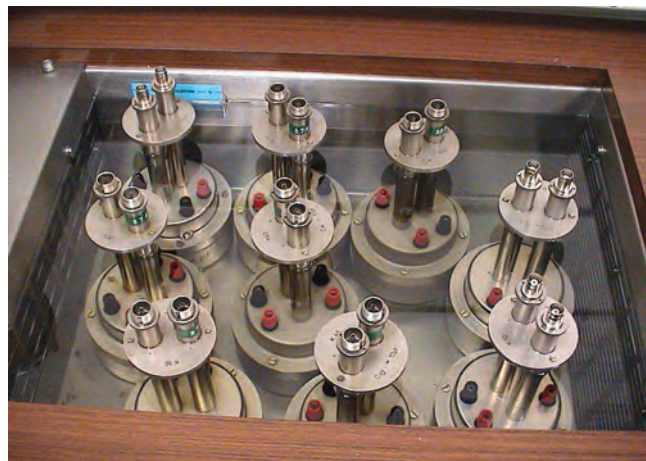
Obr. 2: Křemenné etalony kapacity 10 pF s extrémní stabilitou, vyvinuté v TESLA Brno v roce 1972
