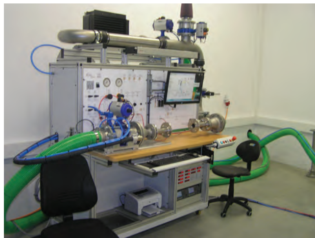
Obr. 3: Řídicí pult a místo pro zkoušená měřidla u zařízení Bell Prover
