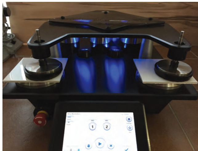
Obr. 2: Zkušební zařízení pro testování odolnosti proti drobnému poškrábání
